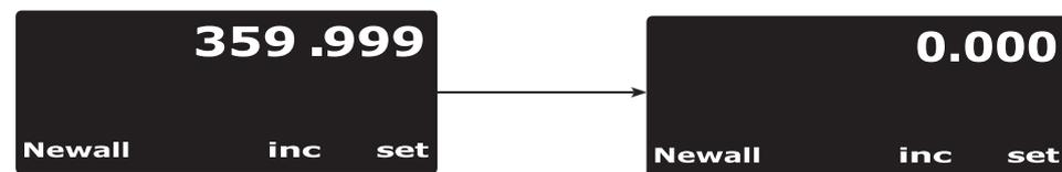
En mode Retour, quand l'appareil approche de 360, il s'arrête à 359,999 et reprend à 0.
